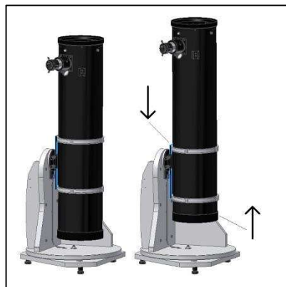
Figura B. Far scorrere l'attacco a coda di rondine del telescopio e serrare saldamente le due manopole.
